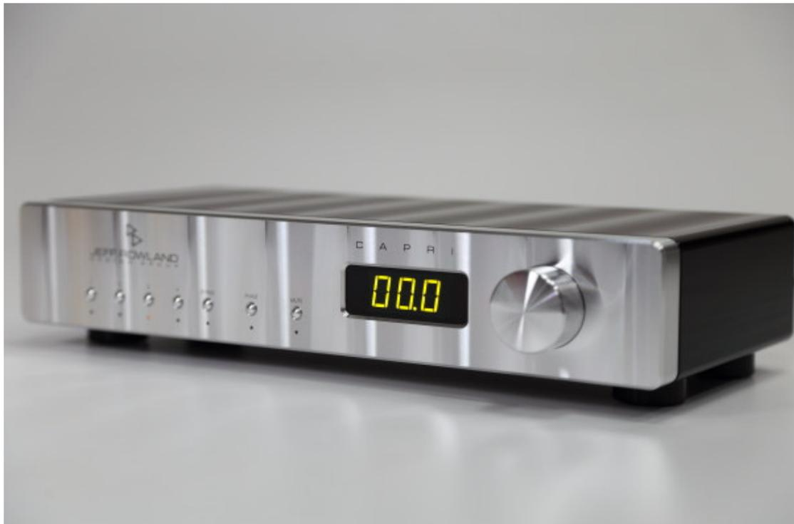
這台 **Capri S2** 前級，在很多方面跳脫了傳統 **Hi-End** 器材的作法。首先，**Capri S2** 搭載了體積小、效率高的交換式電源作為電源供應，而非採用環形變壓器等線性電源。在一般音響玩家的印象中，交換式電源具有高頻噪訊的缺點，但是現在交換式電源的品質已經大幅改進，而很多 **Hi-End** 廠家針對交換式的濾波技術也累積不少了經驗。**Jeff Rowland** 早在 1999 年推出 **Model 10** 與 **Model 12** 時，便將「**Power Buss**」交換式電源運用在其中。運用交換式電源累積將近 20 年經驗的 **Jeff Rowland**，在 **Capri S2** 的機殼內車出一個獨立的區域，將交換式電源安置其中，讓周圍的鋁合金圍牆發揮阻擋外界噪訊與避振的功用，確保 **Capri S2** 擁有乾淨的電源。
